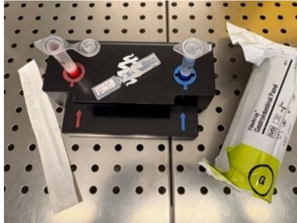
Figura 3. Materiali necessari per la preparazione dell'analisi (rack, fiala di soluzione tampone, fiala con soluzione idratante, fiala per l'iniezione del campione, pipetta di trasferimento e cartuccia FilmArray Gastrointestinal Panel)
