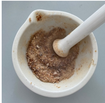
Figura 13. Raffigurazione del dattero polverizzato all'interno del mortaio in trattamento con azoto liquido
