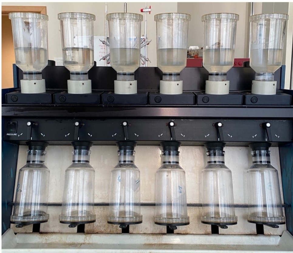
Figura 17. Strumentazione Fibertech per la determinazione della fibra dietetica. Le fiasche superiori contengono il campione in fase di filtrazione, mentre le fiasche inferiori saranno impiegate per la raccolta del filtrato contenente la fibra solubile.
