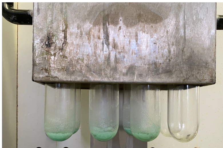
Figura 14. Aspetto del campione dopo la fase di mineralizzazione: la colorazione è tendente al verde in assenza di residui neri.
