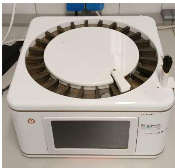
Fig. 3.1 Tester semiautomatico per compresse.
