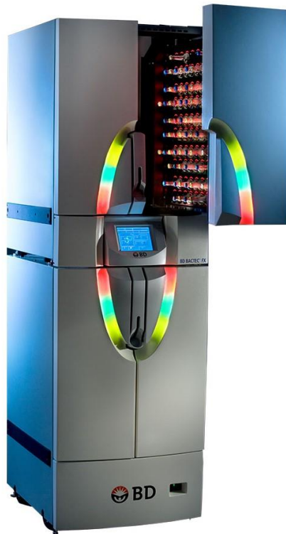
Figura 16 Sistema BD Bactec per il test della sterilità del sangue
