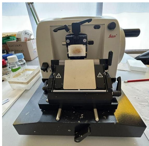
Fig.14 Microtomo con campione incluso in paraffina situato nell'apposito supporto.
