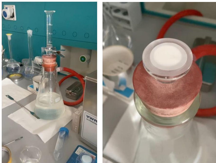
Fig.18 Nell'immagine a sinistra si osserva il sistema filtrante, a destra il filtro di policarbonato.
