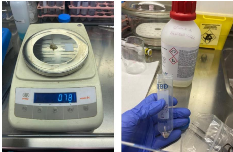
Fig.17 Nell'immagine di destra si osserva la bilancia tecnica per la pesatura del campione, a destra provetta Falcon e NaCl per la digestione.
