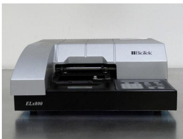
Figura 19_BioTek ELx800 strumento utilizzato per la lettura spettrofotometrica dei test ELISA su micropiastre – Marshall Scientific
