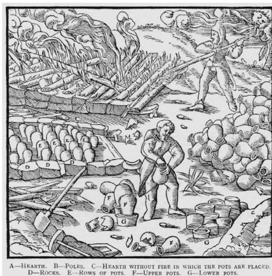
Figura 12 Illustrazione tratta da De Re Metallica (Agricola 1556) che raffigura l'estrazione di Hg dal cinabro in focolari aperti. Numerosi pezzi di minerale di cinabro frantumato venivano posti in vasi di terracotta semisferici, questi venivano poi sigillati con muschio e depositati sottosopra su vasi a fondo piatto infine sepolti nel terreno. I vasi venivano riscaldati su un fuoco, permettendo all'Hg di volatilizzarsi e condensare sulla loro superficie superiore (Parsons and Percival 2005).
