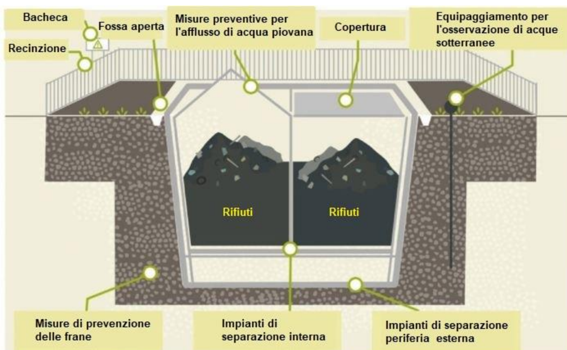
Figura 214. Discarica appositamente progettata in cemento armato a tenuta stagna e coperta con materiale che impedisce l'afflusso di acqua piovana
