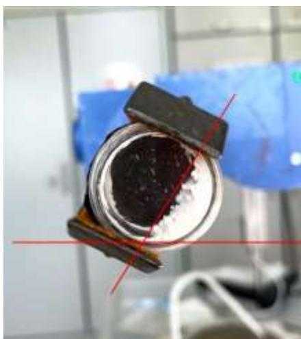
Figura 1: Misura dell'angolo di riposo dinamico della polvere B.
