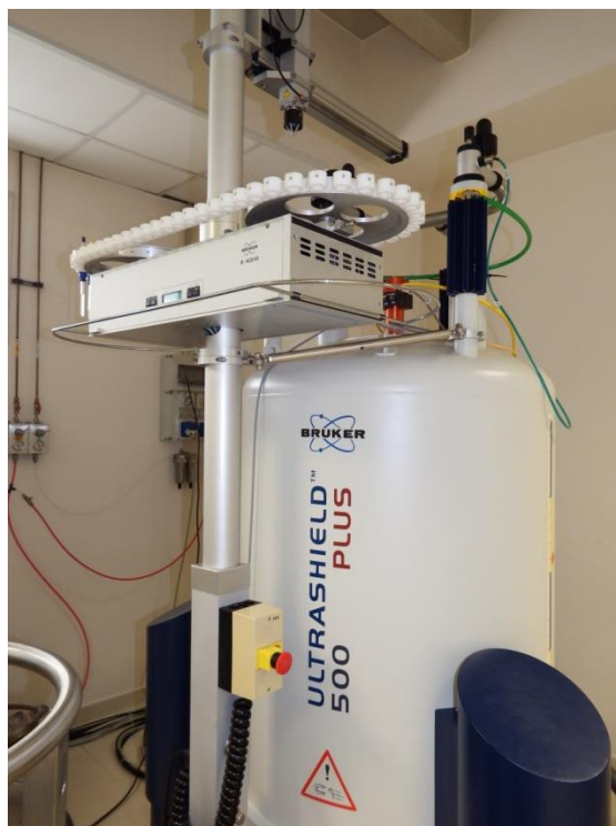
Figura 3.9 Spettrometro NMR Bruker 500 Ultrashield Plus dell'infrastruttura PRISMA dell'Università del Piemonte Orientale.
