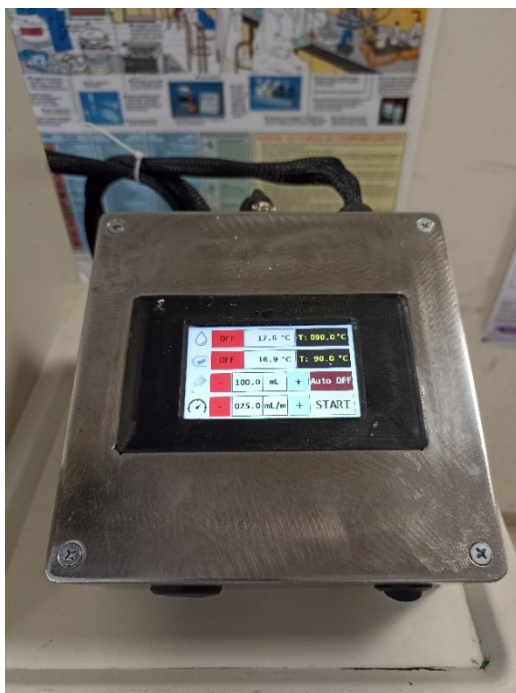
Figura 7: sistema di alimentazione: controller
