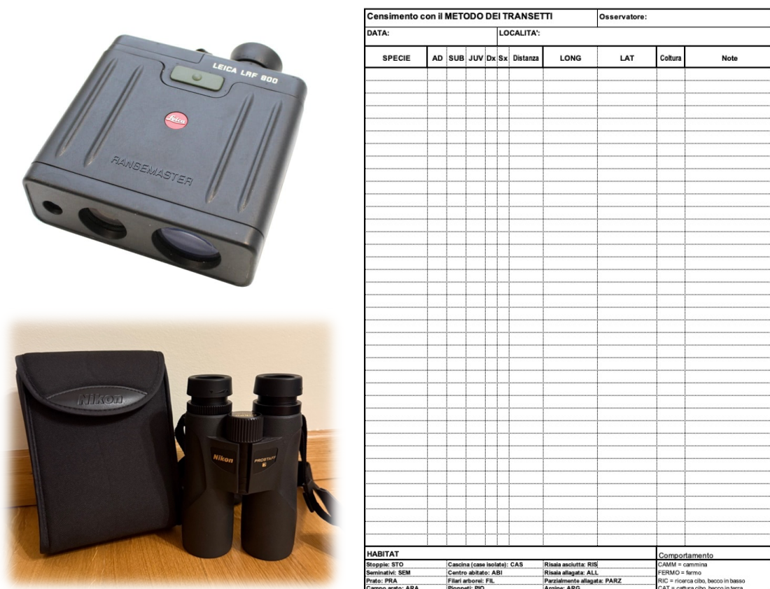
Figura 25: telemetro laser Leica LRF 800 e binocolo Nikon 10x50 a sinistra, scheda di campo per transetti lineari a destra
