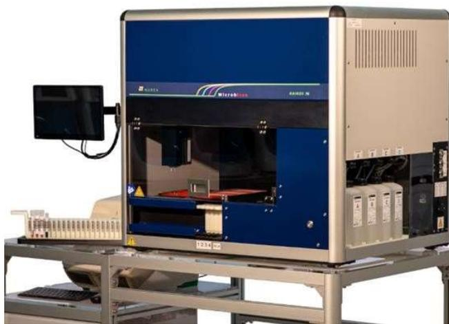
Figura 4 Kairos-96 prodotto dall'azienda Nurex Srl, costituito da un estrattore automatico e da RT-PCR
