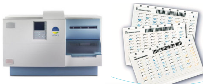
Figura 8: VITEK 2® e card per identificazione GN, GP e YST
