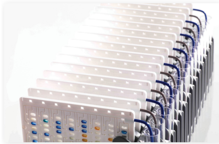
Figura 12: Card ID e AST inserite nella cassetta che verrà introdotta all'interno dello strumento VITEK 2®
