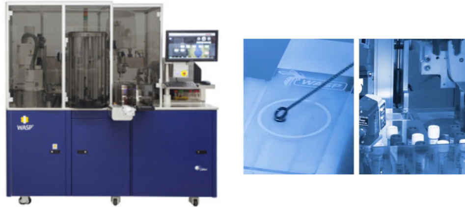
Figura 7: Strumentazione automatizzata Wasp®Lab utilizzata per la preparazione dell'esame microscopico delle emocolture
