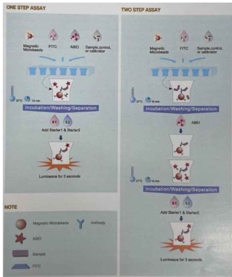
Figura 20: principi di funzionamento di MAGLUMI X3: tecnologia di marcatura con ABEI (sinistra) e tecnologia di separazione con microsfere magnetiche (destra); Snibe Diagnostic
