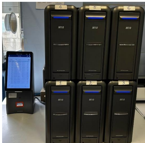
Figura 19. Strumento SD BIOSENSOR – STANDARD M10 costituita da sei moduli per l'inserimento delle cartucce contenenti il campione.
