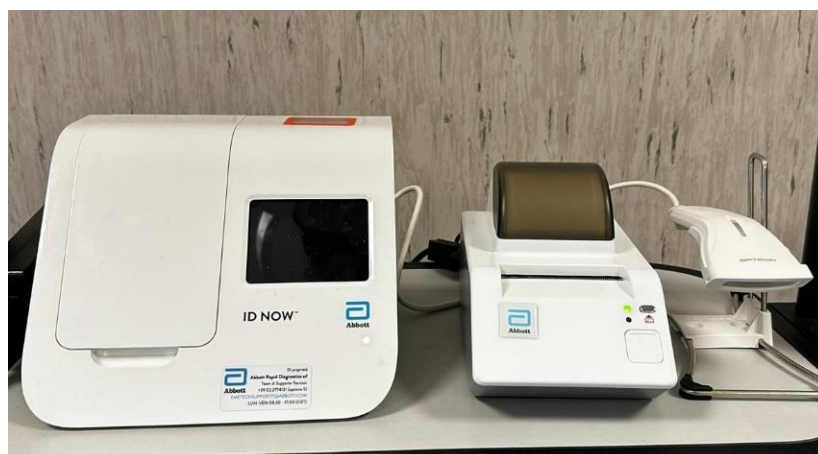
Figura 10. Strumento ID NOW™ collegato con l'apposita stampante per la stampa dei risultati e la pistola per scansione il barcode del paziente presente sul campione.
