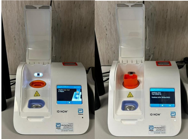
Figura 13. Fase iniziale del test con inserimento della base test.
