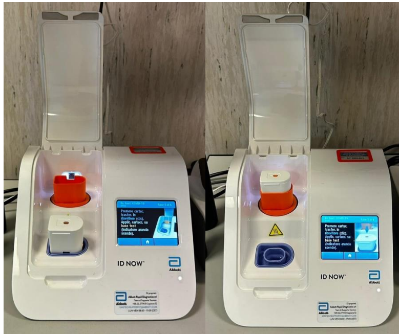
Figura 16. Trasferimento del campione nella base test.
