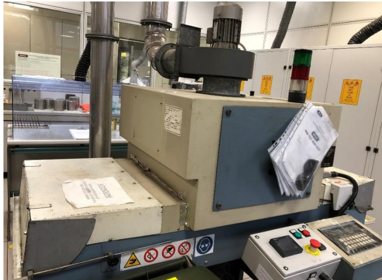
Figura 1.28 : lampada UV/LED presente in Metlac ed utilizzata per scopo di tesi
