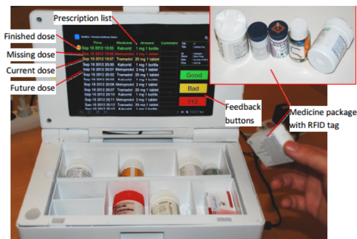
Figura 33: prototipo reale della iMedBox [54]
