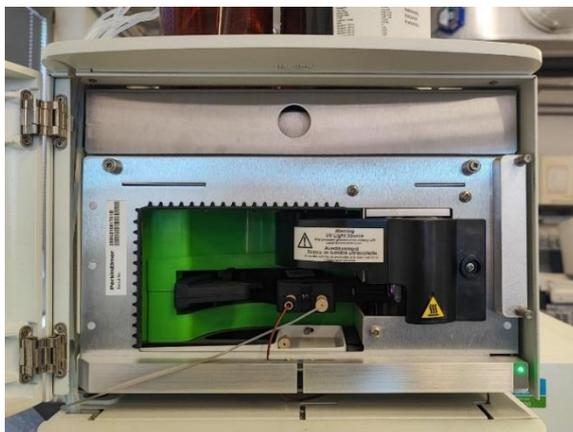
Figura 19: rivelatore a PDA dello strumento HPLC LC300 PerkinElmer.
