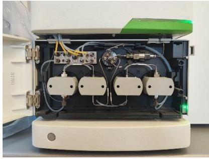
*Figura 14: coppie di pompe dello strumento HPLC LC300 PerkinElmer.*
