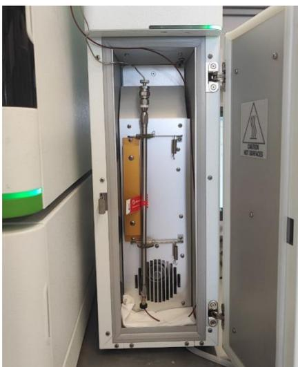
*Figura 18: alloggiamento colonna nel forno esterno dello strumento HPLC LC300 PerkinElmer.*
