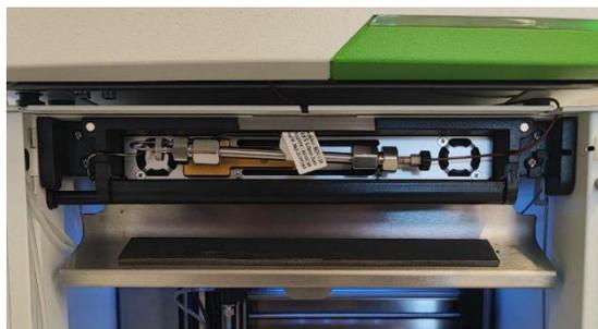
*Figura 16: alloggiamento colonna nello strumento HPLC LC300 PerkinElmer.*
