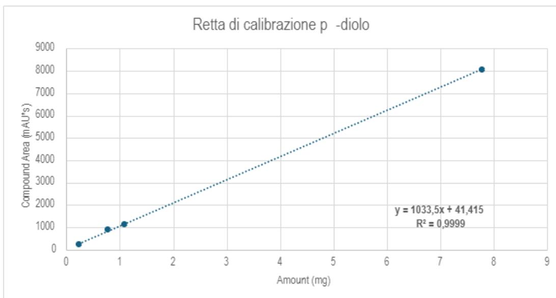
Figura 92: retta di calibrazione costruita per il 2,2'-(1,4-fenil)bis(propan-2-olo) con Acquisition Method BC e Processing Method BC PM.
