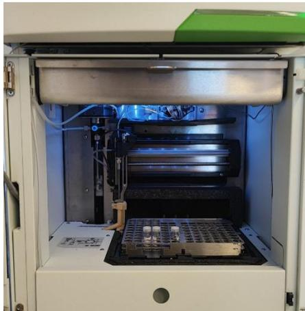
*Figura 15: alloggiamento dello strumento HPLC LC300 PerkinElmer.*
