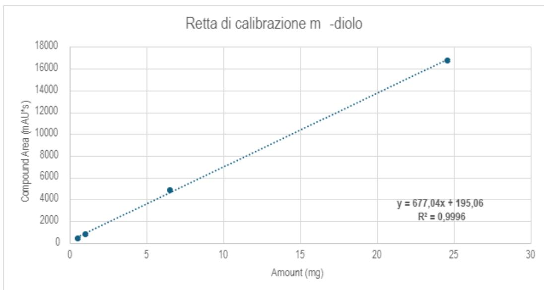
Figura 93: retta di calibrazione costruita per il 2,2'-(1,3-fenil)bis(propan-2-olo) con Acquisition Method BC e Processing Method BC PM.
