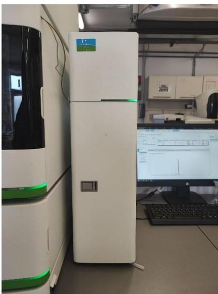
*Figura 17: forno esterno dello strumento HPLC LC300 PerkinElmer.*
