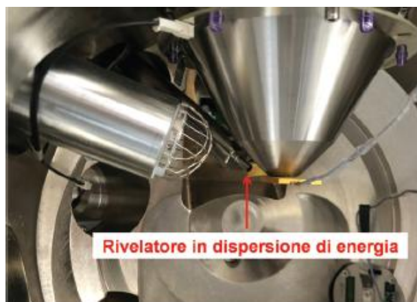
Fig. 39: Rivelatore in dispersione di energia (Rinaudo e Croce, 2020)
