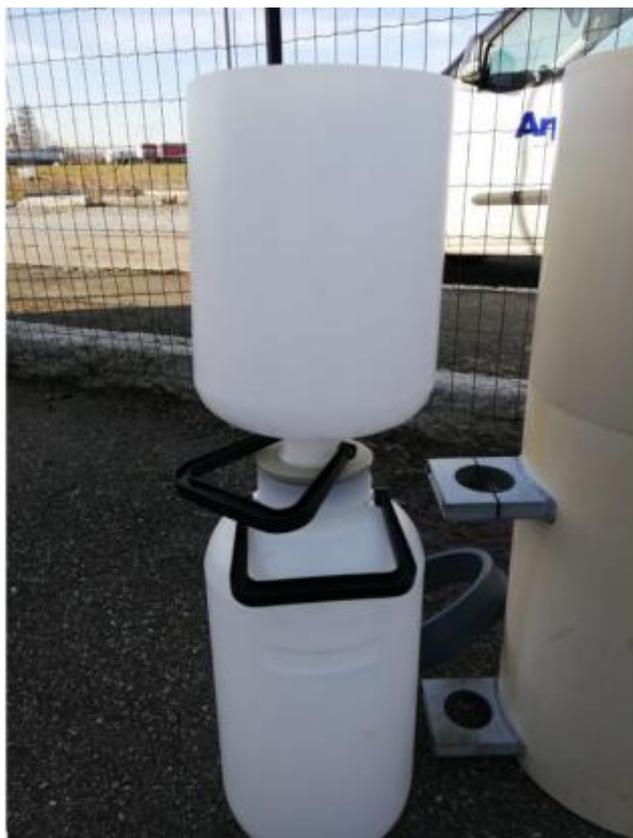
Fig.20 Raffigurazione di un deposimetro usato per il campionamento passivo della matrice aria
