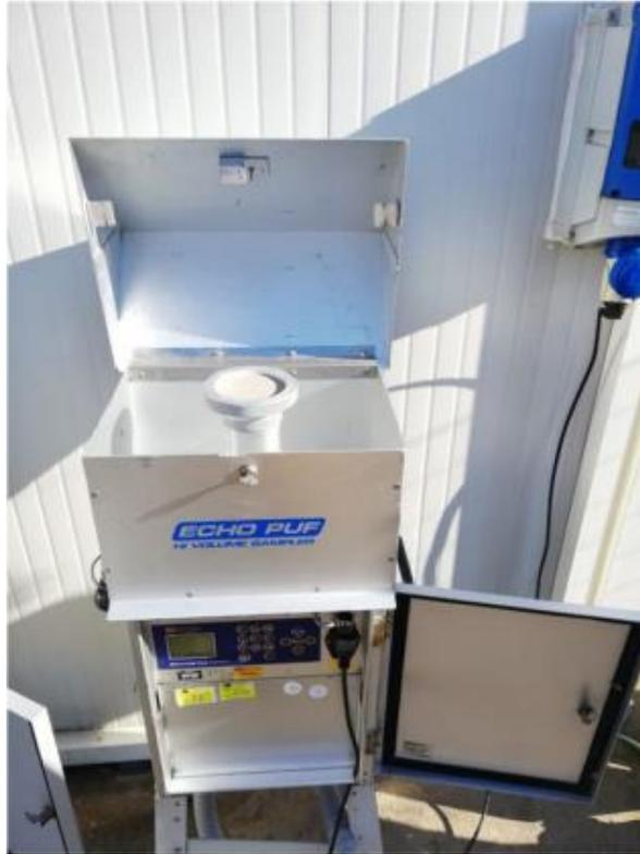
Fig.19 Rappresentazione di un campionatore in fibra di quarzo usato per il campionamento attivo della matrice aria
