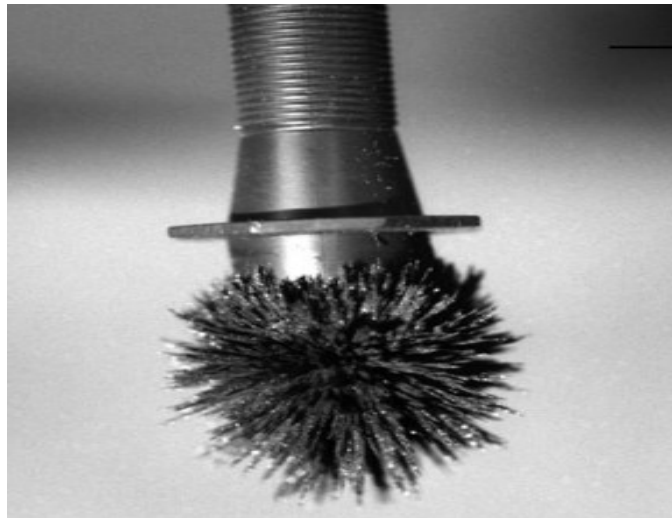
Figura 18: Bacchetta magnetica utilizzata per l'applicazione di polveri magnetiche nello sviluppo di impronte digitali latenti, caratterizzata da un'estremità magnetica che consente l'adesione e il rilascio controllato della polvere senza contatto diretto con il substrato. Yamashita B, French M, Bleay S, Cantu A, Inlow V, Ramotowski R, Sears V, Wake M. Latent print development. In: Yamashita B, French M, editors. Latent print development. Washington (DC): U.S. Department of Justice, Federal Bureau of Investigation; 2013.
