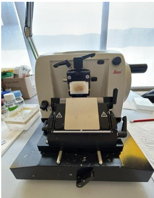
Figura 37: Microtomo con campione incluso in paraffina situato nell'apposito supporto.
