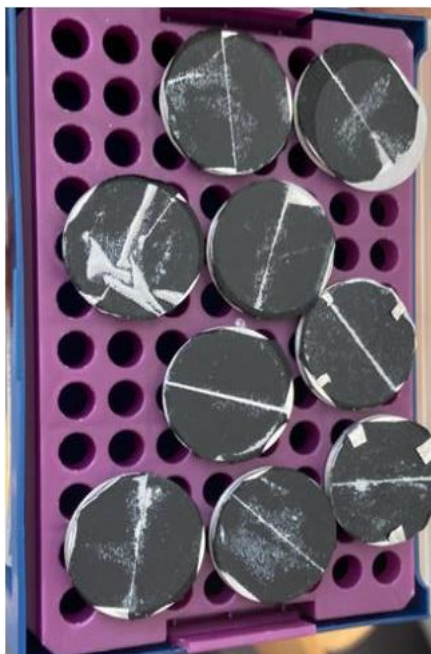
Figura 46: A sinistra supporto porta campioni contenenti i pin stub con i filtri; a destra lo strumento utilizzato per la filtrazione.
