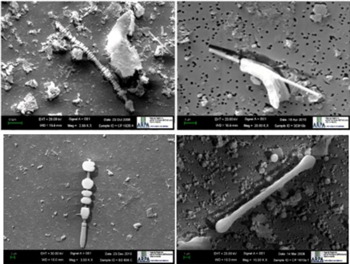
Figura 59: Corpuscoli dell'asbesto in microscopia elettronica a scansione (Gruppo biofibre, 2017).
