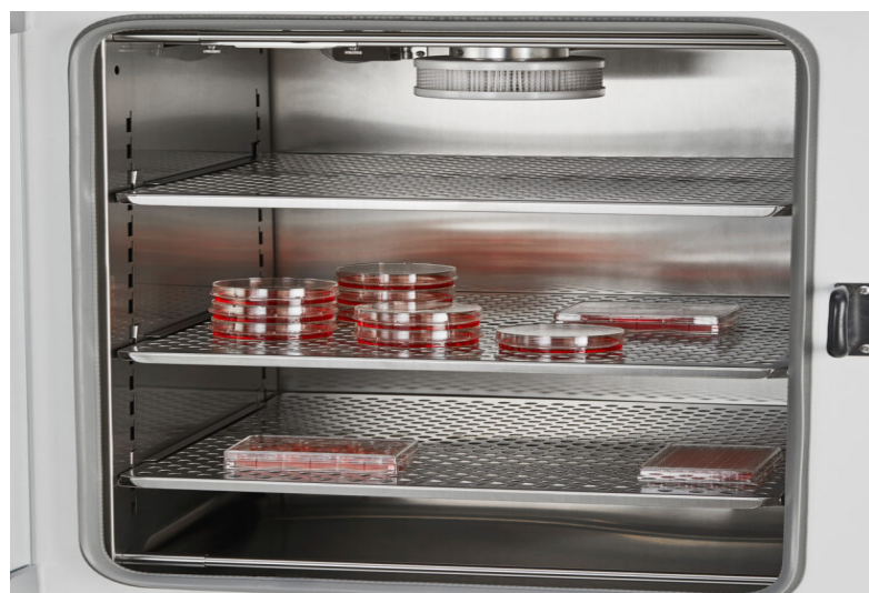
Figura 6. Termostato utilizzato per l'incubazione delle piastre subito dopo la semina
