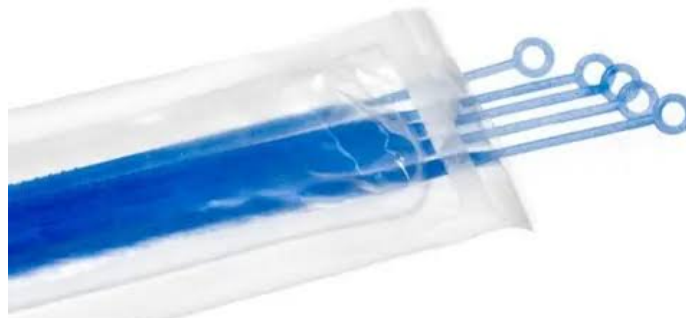
Figura 5. Anse da 10 \mu\text{L} usate per la semina dei campioni sulle piastre imbustate in condizioni di sterilità
