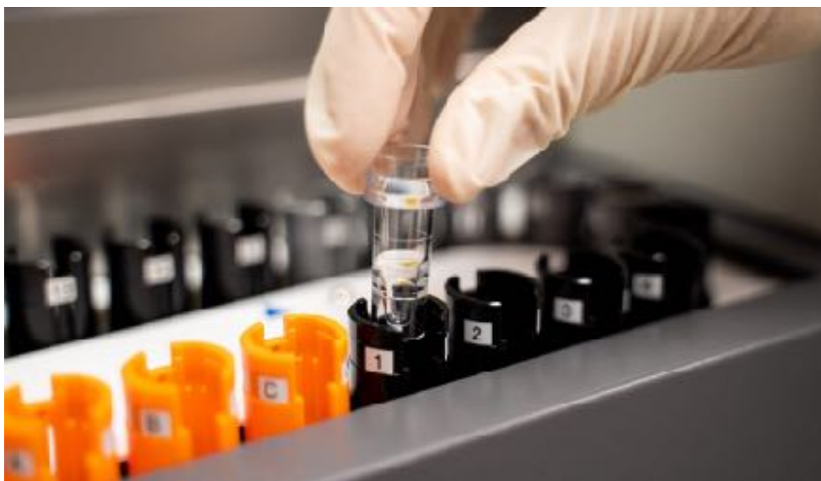
Figura 11: L'interno dello strumento analitico LUMIPULSE® G600. (LUMIPULSE® G600II - a chemiluminescent enzyme immunoassay (CLEIA) analyzer from Fujirebio).
