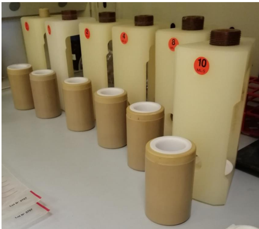
Figura 9 – bombe in teflon per la digestione acida.
