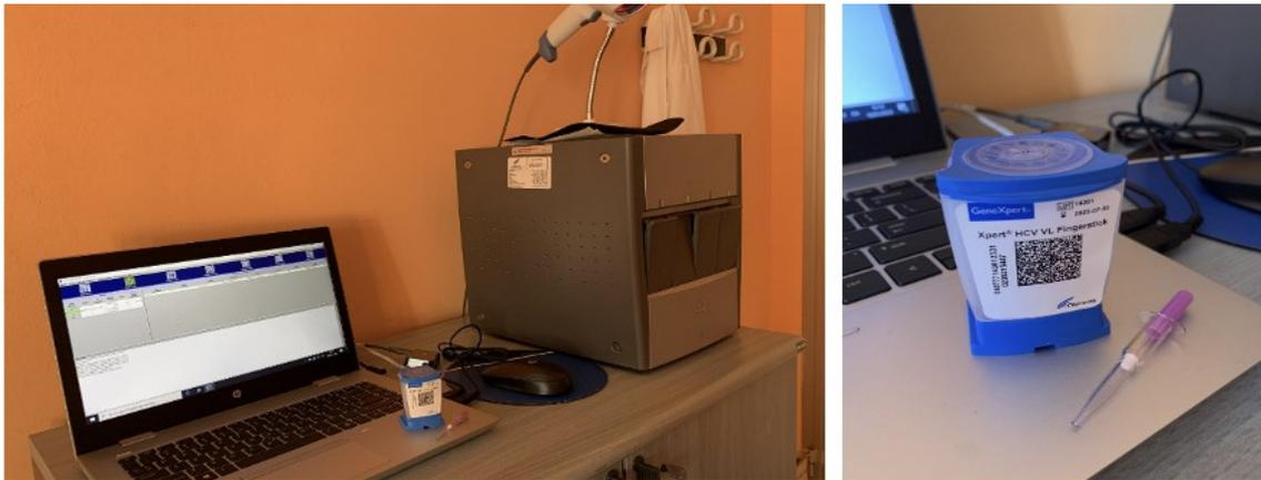
**Figura 9** A) Postazione di screening HCV con lo strumento GeneXpert Dx System - Cepheid; B) Particolare della cartuccia Xpert HCV Viral Load e della Minivette® POCT 100 µL.
