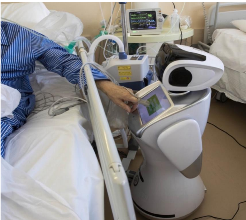
Figura 4: Robot fisicamente assistivo, impiegato nella rilevazione dei parametri vitali.
