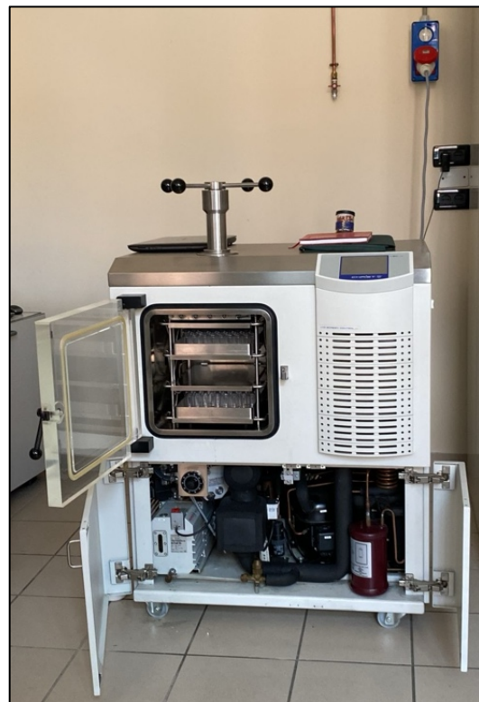
Figura 5: liofilizzatore utilizzato per gli esperimenti
