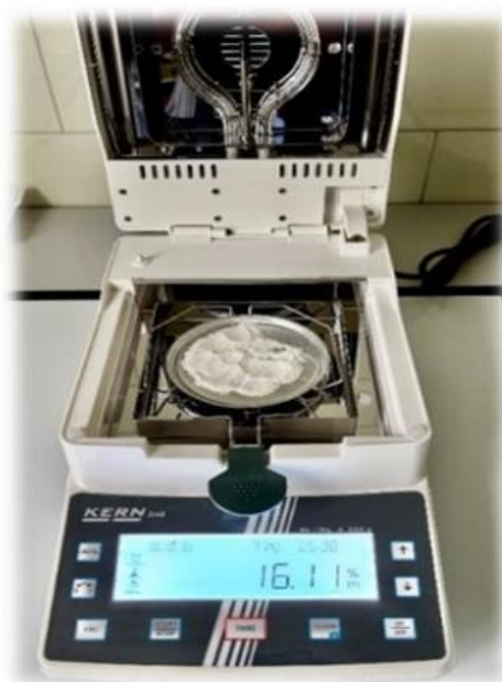
Figura 3.9 - Termobilancia KERN DAB utilizzata per la determinazione dell'umidità della farina raffinata, con visualizzazione del valore percentuale a fine ciclo di essiccamento.
