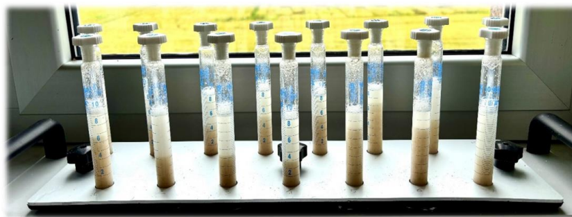
Figura 3.5 - Lettura del volume di sedimentazione in SDS: il livello del sedimento, variabile nei diversi cilindri, è misurato direttamente sulla scala graduata.
