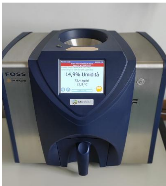
Figura 3.7 - Analizzatore GAC ( Grain Analysis Computer ) impiegato per la misura dell'umidità della granella prima e dopo il condizionamento.
