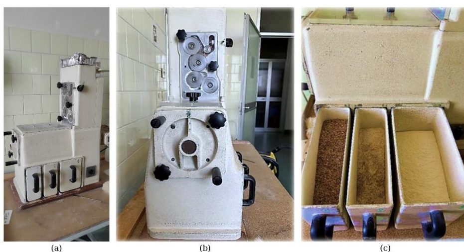
Figura 3.8 - Mulino a cilindri impiegato per la macinazione raffinata: (a) veduta laterale con i cassetti di raccolta delle frazioni; (b) veduta frontale del gruppo dei cilindri; (c) le tre frazioni ottenute: crusca, cruschello e farina raffinata.
