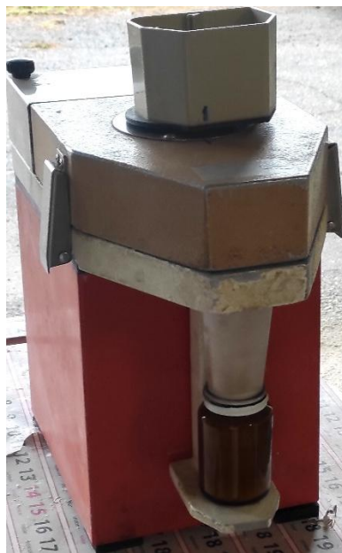
Figura 3.2 – Mulino a ciclone Cyclotec™ 1093 (Foss Tecator), impiegato per la produzione dello sfarinato integrale.
