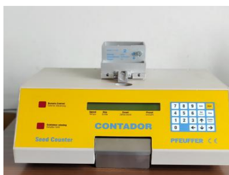
Figura 3.1 - Contasemi automatico Contador (Pfeuffer) impiegato per la conta delle cariossidi nella determinazione del peso di 1000 semi.
