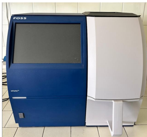
Figura 3.6 - Analizzatore FOSS Infratec™ impiegato per la determinazione dei parametri qualitativi in trasmittanza nel vicino infrarosso.
