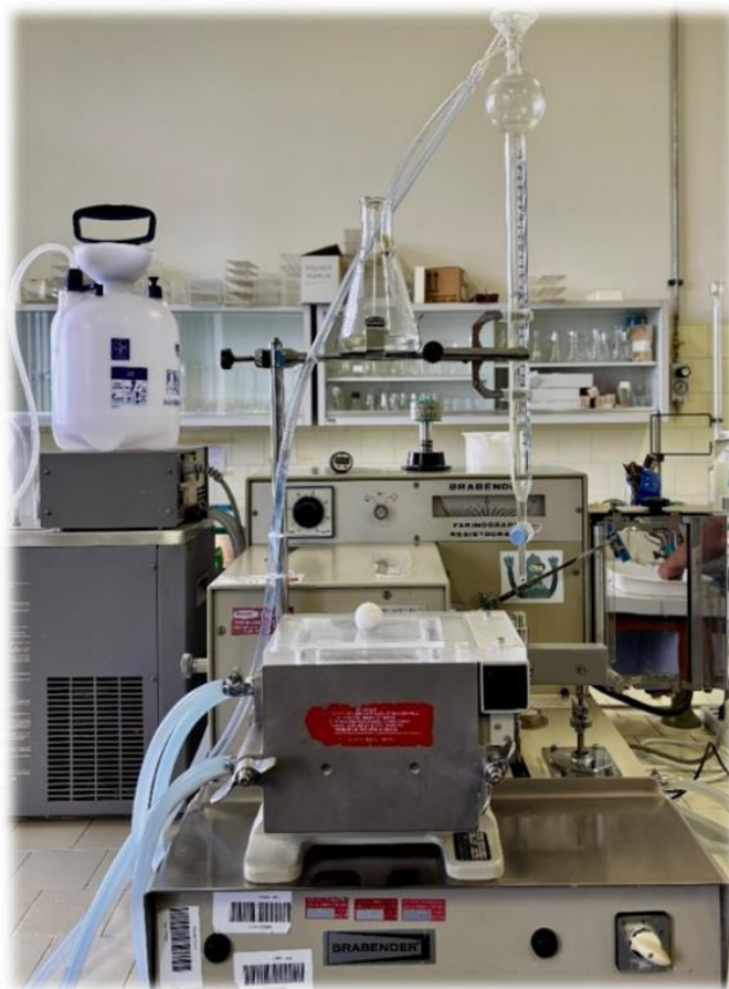
Figura 3.13 - Farinografo di Brabender impiegato per la determinazione delle proprietà reologiche dell'impasto: impastatrice in ghisa, buretta per l'aggiunta dell'acqua distillata e termostato di regolazione della temperatura.
