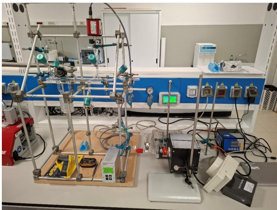
Figura 92: Apparato utilizzato per il pretrattamento dei materiali prima delle misure FT-IR.
