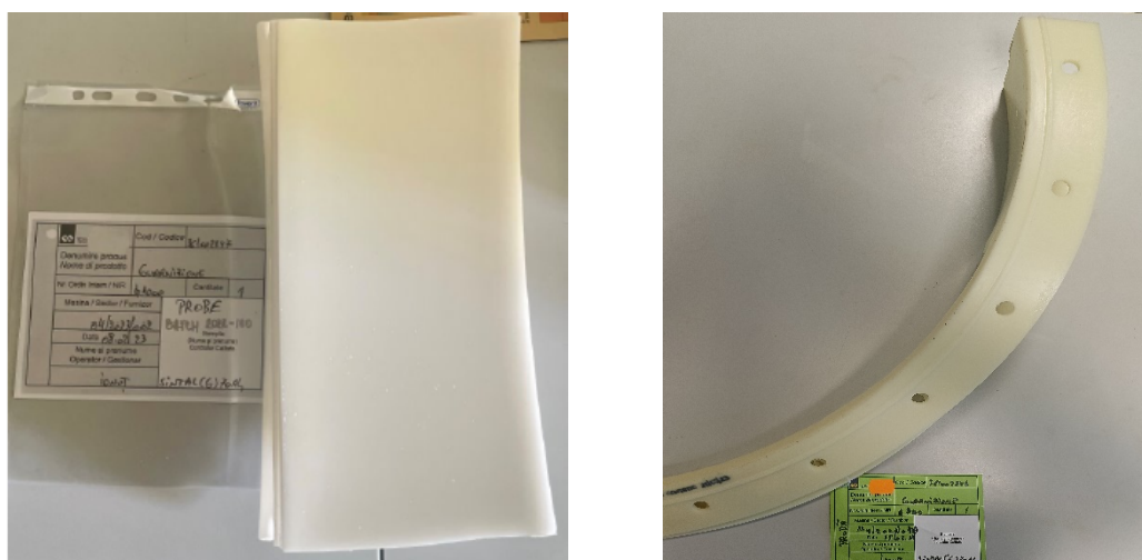
Fig. 23: guarnizioni poliuretaniche fornite dall'azienda, quella del 2023 (sinistra) e quella del 2021 (destra)
