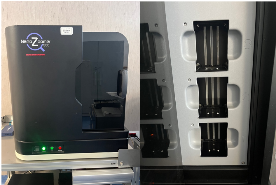
Figura 130: Scanner per Digital Pathology NanoZoomer S60, utilizzato per la digitalizzazione dei vetrini istologici.
