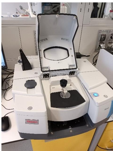
*Figura 7 Spettrometro FT-IR-ATR usato*
