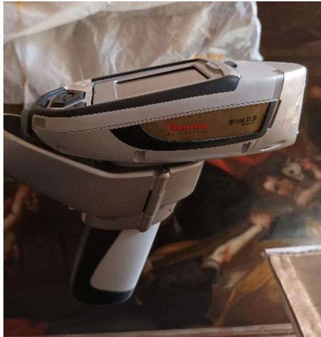
*Figura 6 Spettrometro XRF portatile usato per le analisi*
